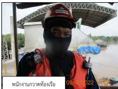
ภาพที่ 3.74 การตรวจวัดปริมาณฝุ่นในสถานที่ทำงาน (TD)
